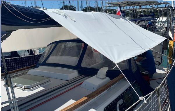
Un' apertura con cerniera nel telo è prevista per il passaggio del mantiglio.
