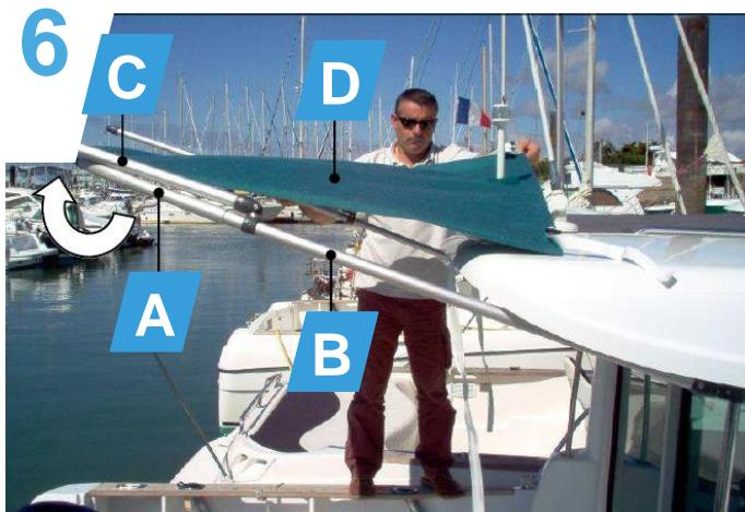
Dopo aver fissato il tettuccio sulla parte inferiore della timoniera, rovesciare la parte rimanente sul tetto per fissarla. Se la timoniera dispone di un'antenna VHF, sarà presente una fenditura per farla passare attraverso il telo.
