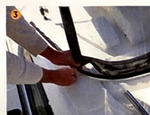
▲ Le pare-brise se zippe par le bas et se glisse en haut dans le tube aluminium.
