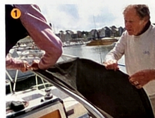
▲ On glisse les toiles dans les deux tubes à double gorge.
