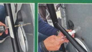
8 Posées sur leurs repères, les platines des pieds vont être vissées. Pour les inserts, on vaporise un peu de graisse pour être certain que les deux filetages en inox ne se grippent pas. Le vissage peut se faire à la visseuse électrique, mais il est préférable, pour plus de précision (et pour éviter d'abîmer la tête de vis), de terminer cette opération à la main, avec un tournevis ou une clé Allen.
