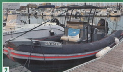
2 Il faut commencer par assembler le toit aux deux pieds, à l'aide des noix de serrage. Ces dernières sont serrées modérément, car elles seront fermement fixées plus tard, à la fin du montage. Le T-top peut être posé dans le cockpit. Une sangle amarrée à l'étrave permet d'éviter qu'il ne bascule vers l'arrière, le temps de la pose.
