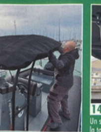
11 Les noix de serrage peuvent être serrées (elles étaient seulement ajustées lors du pré-montage de la deuxième étape). On pourrait se dire que fixer les pieds sans le toit serait plus simple, mais, d'après l'expérience de NVEquipment, il faut éviter cette méthode, car les noix risqueraient de ne pas tomber perpendiculairement aux tubes. Monter le toit avec les pieds permet de rigidifier l'ensemble et facilite la pose.
