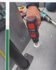
5 Sur ce modèle, le loueur a fait le choix de mélanger les vis « classiques » avec des inserts. Ces derniers offrent une meilleure résistance à l'arrachement et une solidité supplémentaire. Pour être certain de percer à la bonne profondeur, un adhésif est placé sur la machine. Enfin, tous les trous sont fraisés, ce qui apportera une étanchéité supplémentaire, y compris avec le mastic-celle à la silicone.
