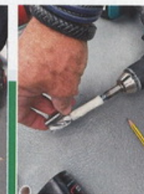
5 Sur ce modèle, le loueur a fait le choix de mélanger les vis « classiques » avec des inserts. Ces derniers offrent une meilleure résistance à l'arrachement et une solidité supplémentaire. Pour être certain de percer à la bonne profondeur, un adhésif est placé sur la machine. Enfin, tous les trous sont fraisés, ce qui apportera une étanchéité supplémentaire, y compris avec le mastic-celle à la silicone.
