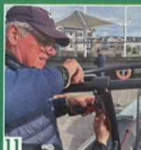
11 Les noix de serrage peuvent être serrées (elles étaient seulement ajustées lors du pré-montage de la deuxième étape). On pourrait se dire que fixer les pieds sans le toit serait plus simple, mais, d'après l'expérience de NVEquipment, il faut éviter cette méthode, car les noix risqueraient de ne pas tomber perpendiculairement aux tubes. Monter le toit avec les pieds permet de rigidifier l'ensemble et facilite la pose.
