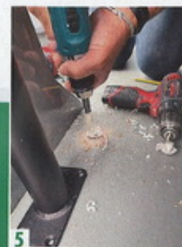
5 Sur ce modèle, le loueur a fait le choix de mélanger les vis « classiques » avec des inserts. Ces derniers offrent une meilleure résistance à l'arrachement et une solidité supplémentaire. Pour être certain de percer à la bonne profondeur, un adhésif est placé sur la machine. Enfin, tous les trous sont fraisés, ce qui apportera une étanchéité supplémentaire, y compris avec le mastic-celle à la silicone.
