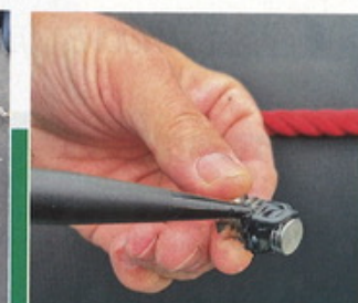
6 Les inserts sont badigeonnés de silicone. Le trop-plein sera retiré ensuite avec une lingette alcoolisée.
