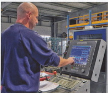
Après défil des longueurs, les tubes sont placés sur une cintreuse à commande numérique (ou manuelle pour les petites pièces) qui assure la bonne conformité géométrique du rayon de cintrage et la répétabilité de l'opération.
