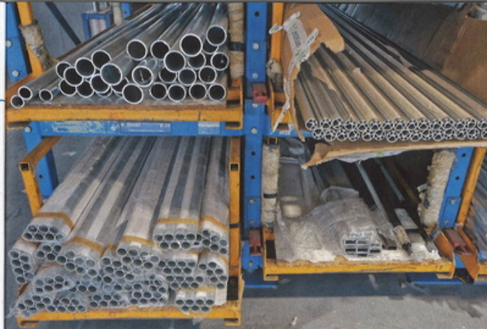
L'atelier métal réalise les structures soutenant la toile à partir de tubes en inox de 23 à 28 mm de diamètre, mais aussi de tubes en alliage léger, moins rigides mais mieux adaptés aux petites unités ou aux grandes structures, de type bimini par exemple.
