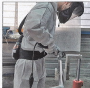
L'armature subit ensuite des opérations de passivation et de polissage qui assurent à la fois l'esthétique et la durabilité, car le bon état de surface de l'innox garantit l'absence de corrosion. Les pièces en alliage léger sont finies par anodisation ou laquage.
