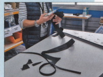
De nombreux éléments, comme ces bavettes en Néoprène, sont réalisés et découpés à la main, en suivant le contour de gabarits tracés par ordinateur.
