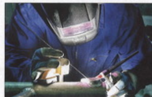
Les structures de grande taille (aluminium ou inox), comme les biminis pour catamaran de croisière, sont assemblées par soudure sur un gabarit réglable afin de garantir à l'ensemble une grande précision géométrique ainsi qu'une rigidité et une résistance optimales.
