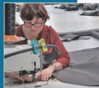
Réalisée sur des machines à simple ou double aiguille, cette opération, dont l'amplitude horaire varie de 30 minutes pour une petite housse à 120 heures ou plus pour une grande fermeture arrière, est essentielle pour obtenir une toile fiable et fonctionnelle. Dans la limite d'une vingtaine d'heures de couture, l'opérateur réalise son produit de A à Z. Au-delà, une équipe de 6 à 8 personnes est nécessaire pour pouvoir manipuler des pièces lourdes et encombrantes, sachant que chaque membre connaît parfaitement tout le processus de fabrication. Une méthode qui développe le savoir-faire individuel, évite le travail posté et facilite, le cas échéant, le remplacement d'un opérateur par un autre. Les vitrages, souples (polyvalents car pliables), semi-rigides (panneaux latéraux, fermetures arrière...) ou rigides (pare-brise), sont assemblés sur la toile par une double piqûre. Ils font l'objet d'un soin tout particulier, car le moindre défaut de montage est susceptible de mettre en péril la géométrie finale de la toile et d'engendrer des plis ou un dysfonctionnement des glissières.
