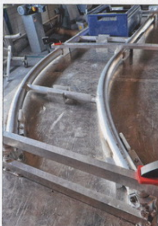
L'alliage léger est également utilisé pour la fabrication des montants de T-top. Réalisée à l'aide de peinture poudrée cuite au four, la finition laquée, noire ou blanche (d'autres coloris sont à l'étude), est confiée à un sous-traitant local, spécialisé dans ce type de travail.
