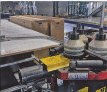
Après défil des longueurs, les tubes sont placés sur une cintreuse à commande numérique (ou manuelle pour les petites pièces) qui assure la bonne conformité géométrique du rayon de cintrage et la répétabilité de l'opération.
