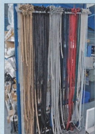
Les fermetures à glissière, renforts en cuir, gainages et autres ralingues en textile sont également préparées en amont des opérations de couture, qui sont le goute d'étranglement incontournable du flux de production.
